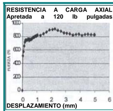
**Fig. 13.** Resultados fuerza al deslizamiento axial, probeta apretada con torcómetro Velocidad del cabezal 12.5 mm/min.
