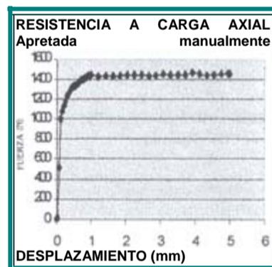
**Fig. 14.** Resultados fuerza al deslizamiento axial, probeta apretada manualmente instrumental se fracturó o falló<sup>4, 9, 24</sup>.
