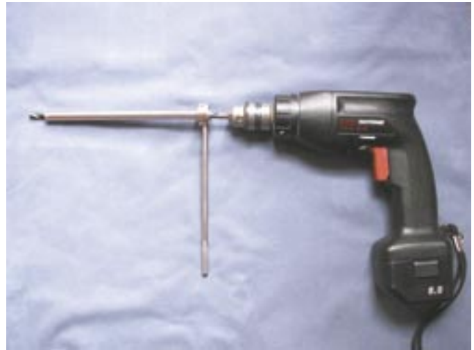
Figura 8: Dispositivo montado con pieza de corte, la punta de la broca, sobresale 1 cm.
