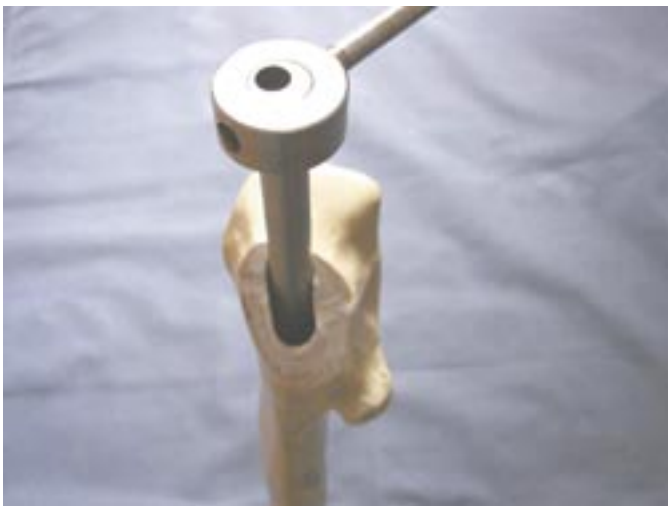
Figura 11: detalle coronal del corte del cemento, con el dispositivo en el interior.
