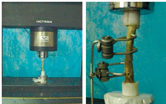
Fig. 3a-b-c. Probetas montadas en máquina Instron 5500
